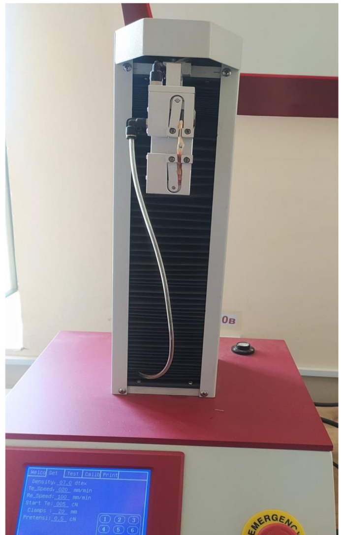
Рис. 3. Общий вид разрывной машины и образцы сухожилия, закреплённые в зажимах Fig. 3. General view of the tensile testing machine and tendon samples secured in clamps
