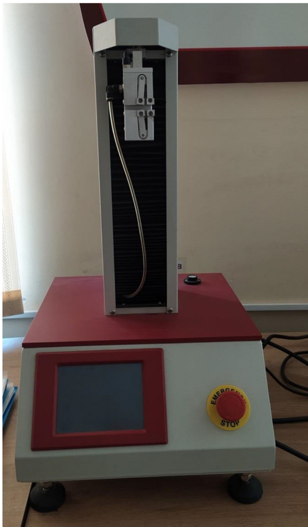
Рис. 3. Общий вид разрывной машины и образцы сухожилия, закреплённые в зажимах Fig. 3. General view of the tensile testing machine and tendon samples secured in clamps
