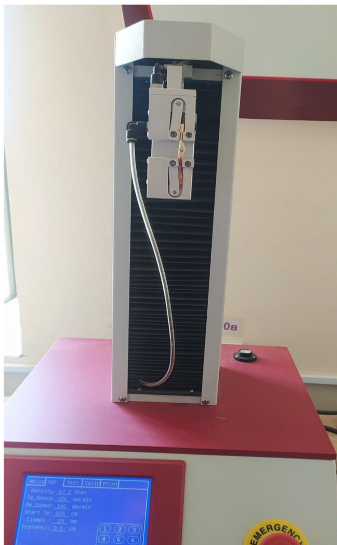
Рис. 3. Общий вид разрывной машины и образцы сухожилия, закреплённые в зажимах Fig. 3. General view of the tensile testing machine and tendon samples secured in clamps
