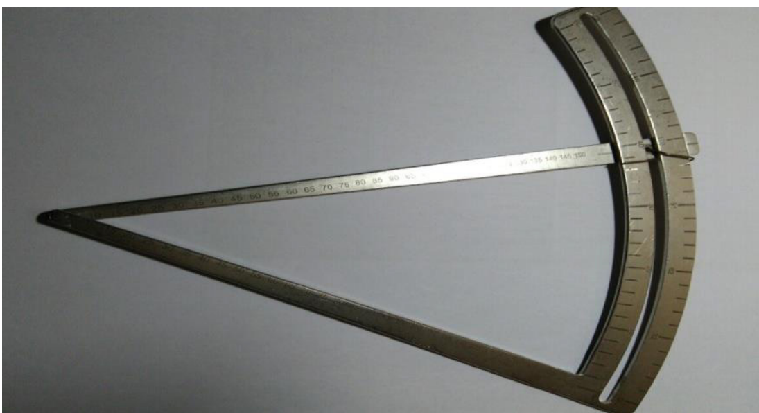
Рис. 2. Инструмент для измерения углов операционного действия с сантиметровой лентой и металлической линейкой
